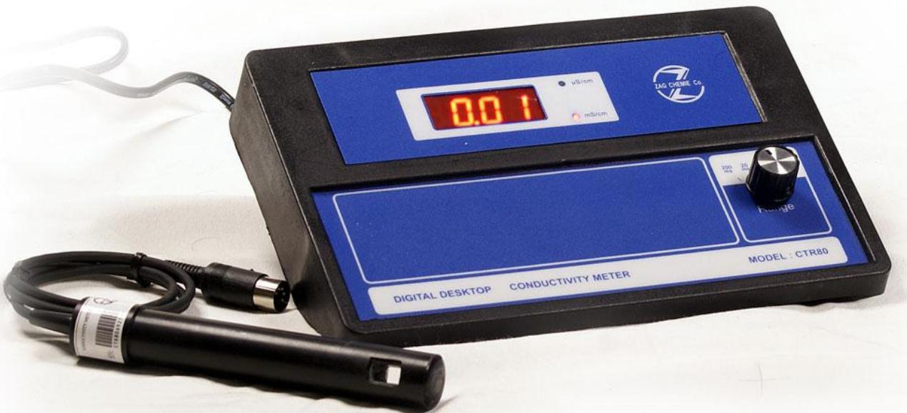
سنجش هدايت الکتریکی يك روش سریع و مطمئن جهت تخمین زدن غلظت یونها در محلول است. هدايت سنجی در علوم و صنایع کاربردهای متعددی دارد که اندازه گیری غلظت یونها در محلولهای آبی مهمترین کاربرد آن به شمار می آید.
